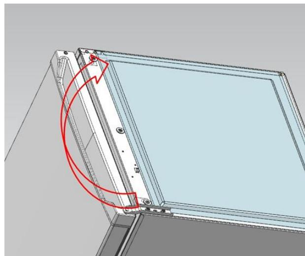
8. Die Gerätetür vertikal und horizontal ausrichten und darauf achten, dass die Dichtungen gut schließen. Eventuell die Scharniere nachjustieren.
