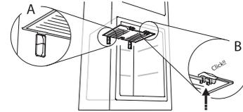
7. Setzen Sie die obere Schublade wieder ein und schließen Sie die Gefrierfachtür.
