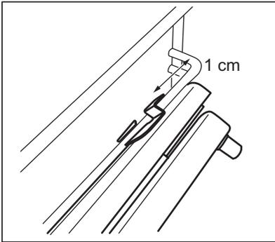
3. Drehen Sie den Auszug in die richtige Position. Das Anschlagstück, das sich an einem Ende des Auszugs befindet, muss nach oben weisen.
