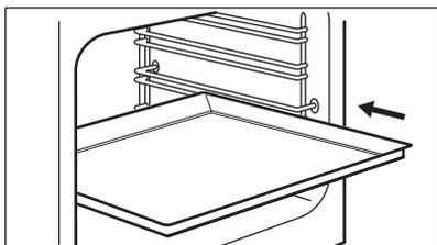
Schiebe das Backblech oder die Auflaufpfanne zwischen die Führungsschienen der Einhängegitter. Stellen Sie sicher, dass es die Rückwand des Backofens nicht berührt.
