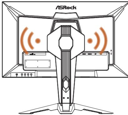
Zwei Antennenanschlüsse befinden sich an der Rückseite des Monitorständers. Verbinden Sie ein Ende des Antennenkabels mit dem Antennenanschluss am Ständer und ziehen Sie es sicher fest. Schließen Sie dann das andere Ende am Antennenanschluss am PC oder Laptop an.
