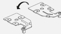
25. Die Schraubloch-Abdeckung (1) oben links entfernen und auf der rechten Seite (2) anbringen.
