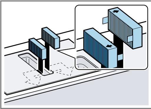
4. Die anderen Geruchsfilter oder Akustikfilter links und rechts in das Gerät einsetzen.
