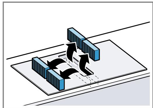
3. Die zwei neuen Geruchsfilter oder Akustikfilter links und rechts in das Gerät einsetzen und nach vorne schieben.
