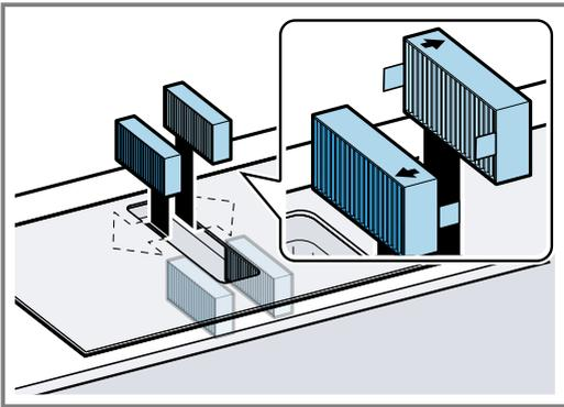
5. Den Fettfilter in das Gerät einsetzen.
