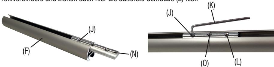
Möchten Sie einen Träger (siehe Schritt 3) genau bei der Profilstückelung setzen, kann der Nutstein (E) vom Träger (C) abgenommen werden (Nutstein wird nicht mehr benötigt). Nun drehen Sie die Schraube (D) in das mittlere Loch des Profilverbinders (N). Wird beim Profilverbinder kein Träger gesetzt, ziehen Sie die Schraube (O), welche in der Mitte vom Profilverbinder befestigt ist, ebenfalls fest.
