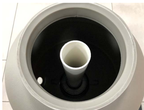
Abb. Innenverrohrung stehend (mittig) im Filterkessel
