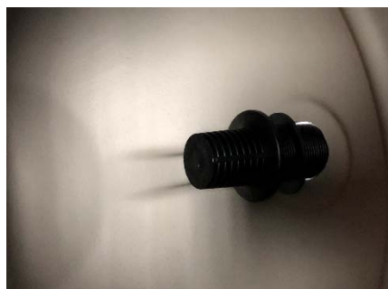
Abb. Filtersieb mit Dichtung im inneren vom Filterkessel
