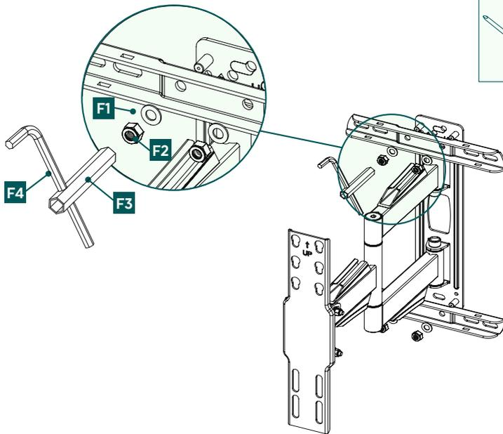
Montieren Sie zunächst die beiden Streben mithilfe von Rohrsteck- [F3] und Inbusschlüssel [F4] an der Wandbefestigungsplatte. Beachten Sie dabei die oben aufgeführte Kombination aus Flanschnutter [F2] und Unterlegscheibe [F1].
