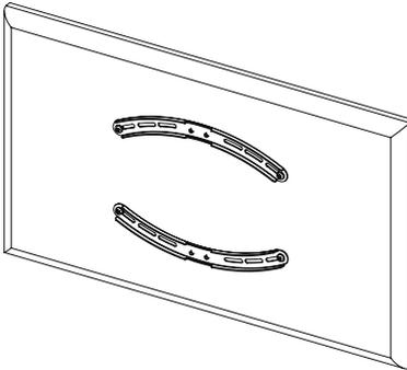
Beachten Sie bei der Positionierung der VESA-Arme auf der TV-Rückseite die entsprechende VESA-Aufnahme. Die VESA-Arme müssen, je nach benötigter VESA-Variante, unterschiedlich ausgerichtet werden. Diese werden entweder nach außen (siehe 6.3.1) oder nach innen (siehe 6.3.2) gewölbt platziert.
