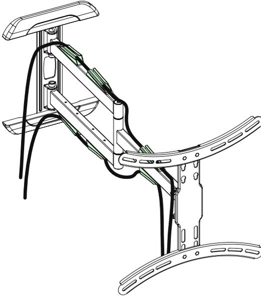
Die Halterung ist mit vormontiertem Kabelmanagement versehen.
