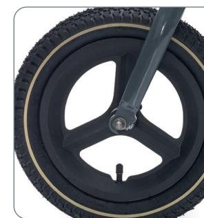
Vložte těsnění pro přední kolo a utáhněte šrouby.
