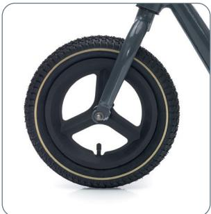
Namestite sprednje kolo: Najprej postavite sprednje kolo na sprednji vilici.
