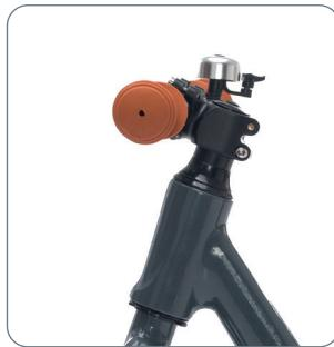
Montering av styret: Skru ut de fire skruene på styret, plasser styret inn og stram de fire skruene.
