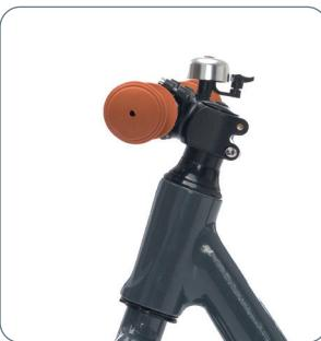
Kormány szerelése: Csavarozza ki a kormány négy csavarját, helyezze be a kormányt, majd húzza meg a négy csavart.
