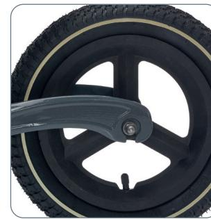
Inserire la guarnizione della ruota posteriore e stringere le viti.
