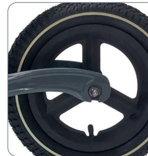
Helyezze be a hátsó kerék tömítését és húzza meg a csavarokat.
