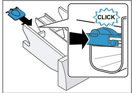
4. Die Waschmittelschublade einsetzen.
