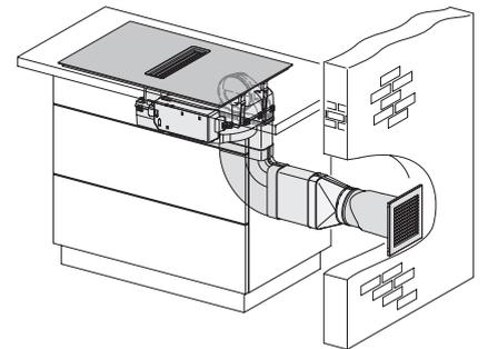
KMDA7676FL, KMDA7876FL – Einbauvariante 11 Abluft – Skizze
