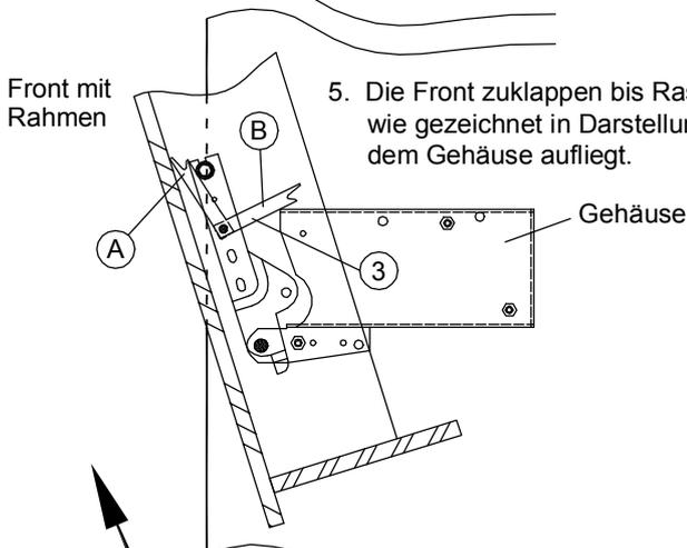
5. Die Front zuklappen bis Rasthebel ③ wie gezeichnet in Darstellung B auf dem Gehäuse aufliegt.
