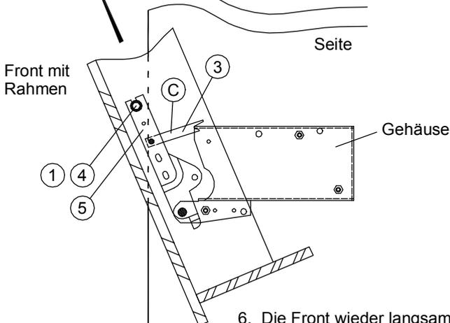
6. Die Front wieder langsam öffnen, bis der Rasthebel ③ in Stellung C am Gehäuse einrastet.
