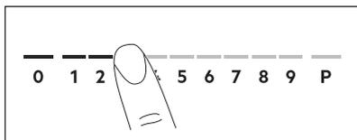
1. Drücken Sie die gewünschte Kochstufe auf der Einstellskala. Die Anzeigen oberhalb der Bedienleiste erscheinen bis zur gewählten Heizstufe.
