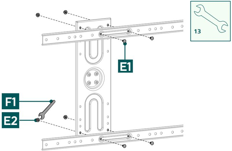
Montieren Sie die VESA-Arme mit den Schrauben [E1] und Schraubenmutter [E2] an die TV-Platte. Befestigen Sie diese mit dem mitgelieferten Schraubenschlüssel [F1].
