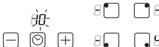
Die Anzeige des Timer-Sensors 15 wechselt von -- auf 10, und die „10“ beginnt zu blinken. Der kleine Punkt rechts unten unter der Leistungsanzeige 4 blinkt ebenfalls.
