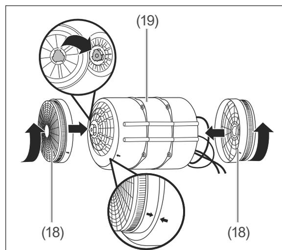
5. Setzen Sie die neuen Aktivkohlefilter (18) wie dargestellt rechts und links auf den Motor (19) auf und drehen Sie sie gegen den Uhrzeigersinn fest. Lassen Sie dabei die Verriegelungen einrasten.
