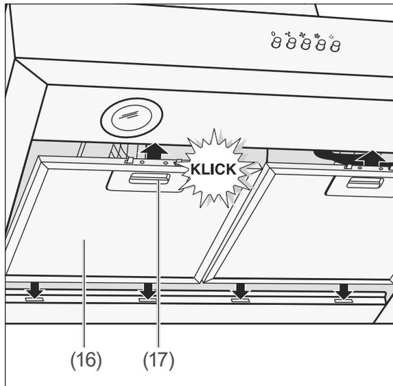
6. Setzen Sie einen Fettfilter (16) mit den Zapfen in die Aussparungen.
