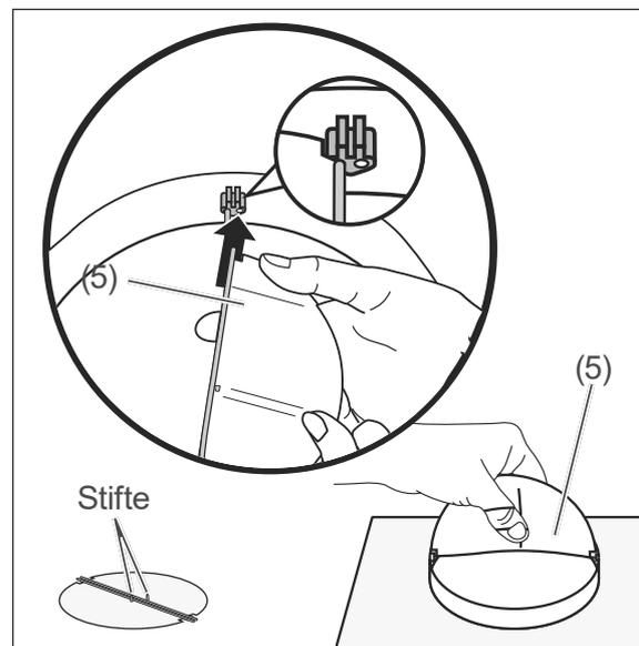
1. Setzen Sie die beiden Hälften der Rückschlagklappe (5) in die Öffnung oben auf die Dunstabzugshaube (1). Achten Sie darauf, dass die Stifte auf den Klappen außen liegen.
