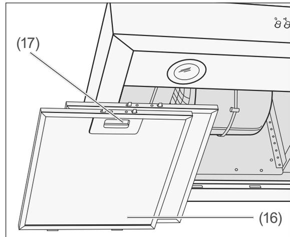
2. Lösen Sie die Verriegelung (17) und entnehmen Sie den Fettfilter (16) vorsichtig.
