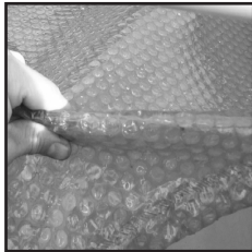
Pincez la bâche ( bulles à l'intérieur). Percez à travers la bâche à 2.5 cm du pli
