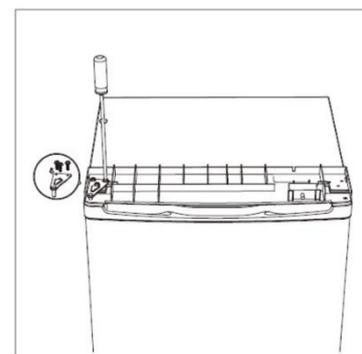
17. Arbeitsplatte auflegen und hinten mit den beiden Schrauben befestigen.
