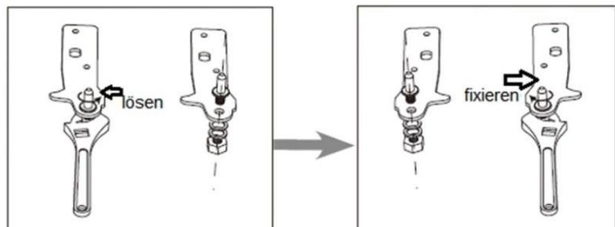
9. Unteres Scharnier mit den beiden Befestigungsschrauben anschrauben.
