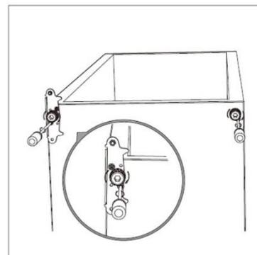
13. Stift des oberen Scharniers in das obere Türloch einsetzen.
