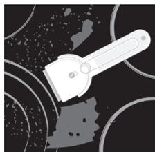
Entfernen Sie stärkere Verunreinigungen mit Spezialreinigern für Glaskeramikoberflächen. Beachten Sie dabei die Gebrauchsanweisung des Reinigungsmittelherstellers. Achten Sie darauf, dass Sie nach dem **Reinigen das Reinigungsmittel gründlich abwischen, weil die Reste des Reinigungsmittels beim Erhitzen die Glaskeramikoberfläche beschädigen können.**
