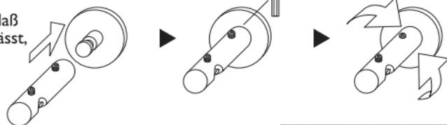
Schieben Sie nun auf einer Seite das Profil so weit durch den Träger hindurch, daß Sie es anschließend bequem durch den/die anderen Träger zurückschieben können.
