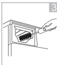
Reinigen Sie die Aussparung mit einer alten Zahnbürste
