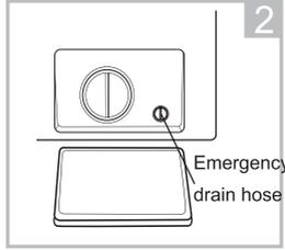
Drehen Sie den Verschluss um 90°, ziehen Sie den Notablaufschauch heraus und nehmen Sie den Schlauchstopfen ab.
