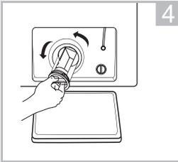
Öffnen Sie den Filter, indem Sie ihn nach links drehen.
