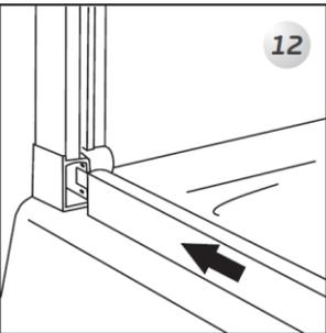
Befestigen Sie die beiden Wandprofile mit den gelieferten Schrauben
