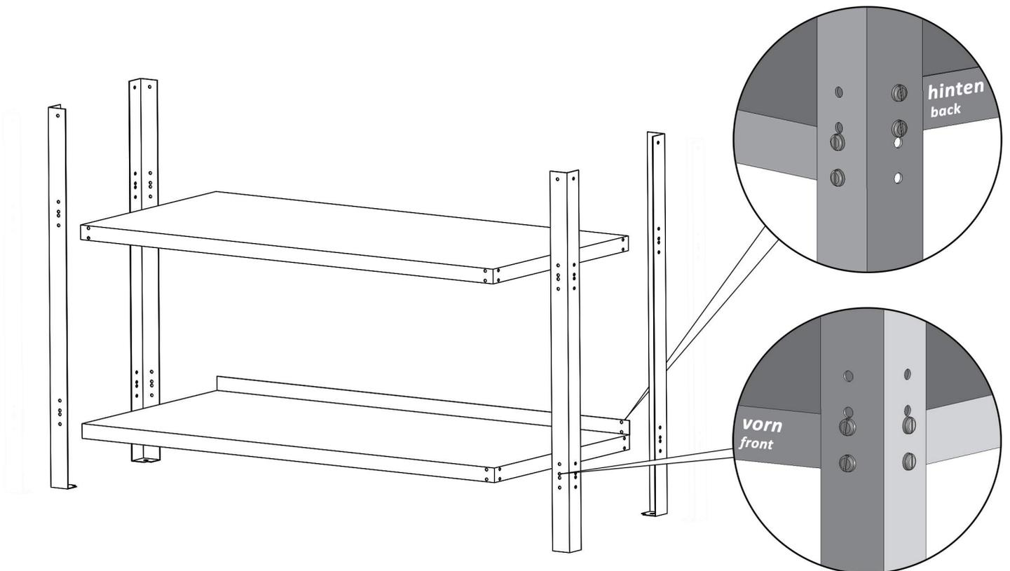
Schrauben Sie mit Hilfe von sechzehn Schraubensets (8) alle vier Tischbeine (1) zuerst an den unteren Fachboden (4). Nutzen Sie an der Vorderseite die beiden untersten Löcher, an der Rückseite die beiden obersten. Die Schraubenköpfe platzieren Sie außen, die Muttern und Unterlegscheiben innen. Bringen Sie nun auch den oberen Fachboden (3) an den Tischbeinen an. Hier können Sie die gewünschte Höhe selbst wählen.
