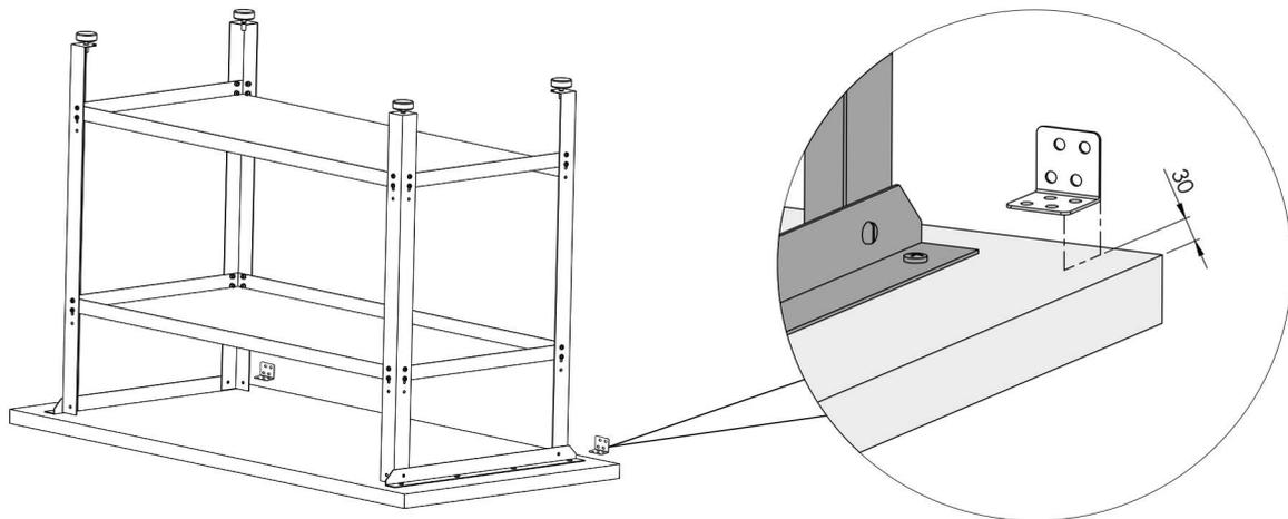
Schrauben Sie die beiden Anbauwinkel (7) mit Hilfe von jeweils vier Schneidschrauben (9) mit einem Abstand von 30 mm zu den Ecken auf der Rückseite der Arbeitsplatte. Stellen Sie die Werkbank wieder auf.
