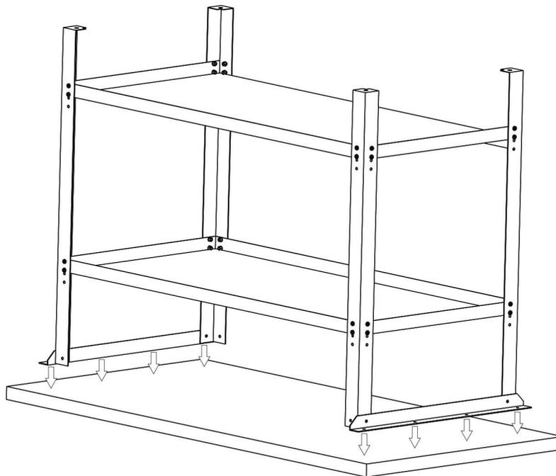
Schrauben Sie mit Hilfe von acht Schneidschrauben (9) die Konstruktion auf die Markierungen der Unterseite der Arbeitsplatte (5).
