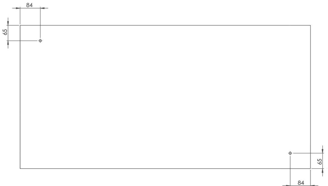
Markieren Sie die benötigten Befestigungspunkte auf der Unterseite der Arbeitsplatte (5).
