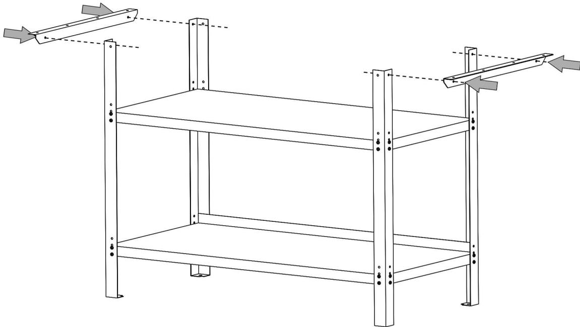
Schrauben Sie die beiden Verbindungswinkel (2) an die obere Seite der Tischbeine.
