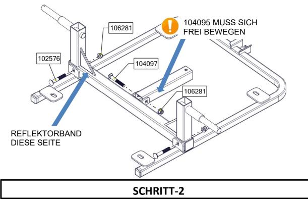
1. VERWENDEN SIE DIE BAUGRUPPE AUS SCHRITT 1 UND BRINGEN SIE DIE REIFEN MIT DEN BEFESTIGUNGEN WIE ABGEBILDET AN.
