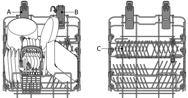
Der Unterkorb verfügt über klappbare Ablagen **C**, die in vertikaler Stellung für Teller oder in horizontaler (niedriger) Position für Pfannen und Salatschüsseln verwendet werden können.
