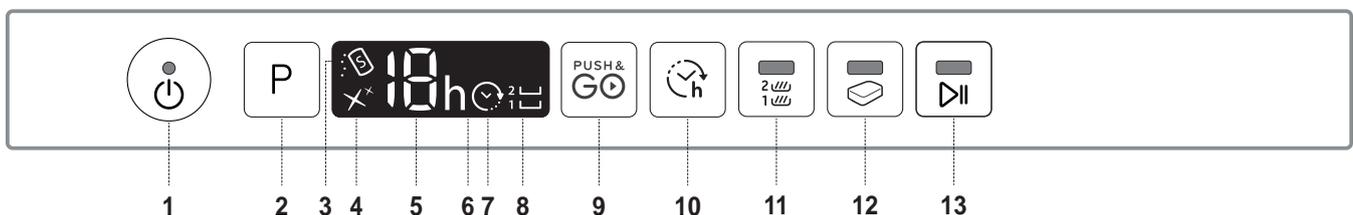
1. Ein-Aus/Reset Taste mit Anzeigelicht
