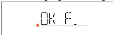
Wenn das Display die entsprechende Nachricht anzeigt, bei Bedarf die *Auswahl-/Bestätigungstaste* drücken, um einen fünfminütigen Bräunungszyklus zu starten.
