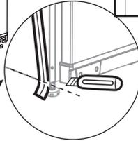
**Not:** 2-3 numara ile gösterilen montaj adımında üst bağlantı plastiğini kaydırabilmek için bağlantının yapıldığı vidaları tam sıkmayınız.
