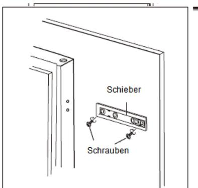
4. Die Führung von der Gerätetür lösen und an dem Schieber fixieren.
