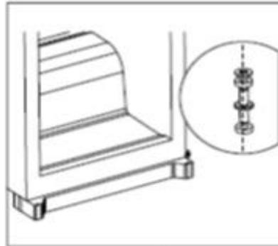
4. Den mittleren Winkel und das mittlere Scharnier mit den beiden Schrauben fixieren. Den Stift vom mittleren Scharnier auf das Loch der Gerätetür stecken. Die obere Gerätetür nehmen und auf den Stift des mittleren Scharniers stecken. Die Gerätetür vorsichtig schließen.
