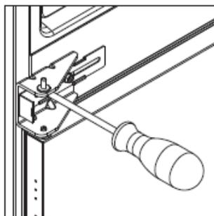
Den Stift vom oberen Scharnier lösen, das Scharnier um 180° drehen und den Stift wieder einsetzen.
