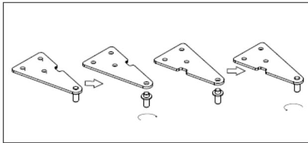
Das obere Scharnier nehmen und den Stift in das vorgebohrte Loch an der Gerätetür einstecken.
