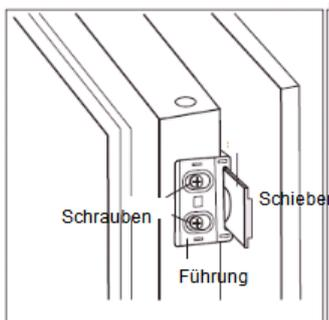
2. Die Gerätetür und die Einbautür öffnen, nehmen den Schieber aus der Führung und markieren an der Einbautür die Löcher für die Schrauben des Schiebers
