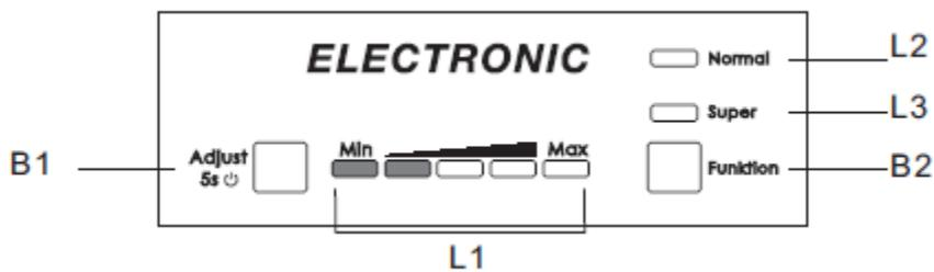
B1 Temperaturregler (Mögliche Einstellungsstufen Min-Max )
