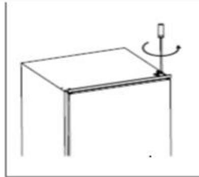
2. Den mittleren Winkel lösen und anschließend das mittlere Scharnier. e Gerätetür anheben und zur Seite legen.
