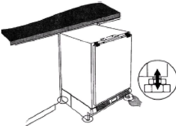
4. Nach dem Einsetzen des Gerätes in die Nische (Abb. 3) müssen Sie die Höhe mit Hilfe der 4 einstellbaren Füße regulieren (Abb. 2). Die Höhe kann zwischen 82 und 87 cm reguliert werden.
