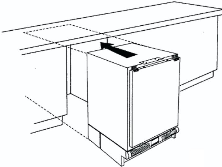
Das Gerät mit den dafür vorgesehenen oberen Befestigungslöchern (Abb.4) an der unteren Arbeitsfläche festschrauben.
