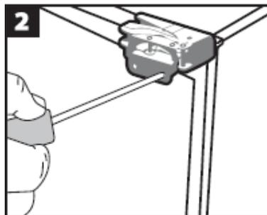
Die Stopfen (1) vom Gerät entfernen, anschließend das Scharnier (2) von der Gerätetür lösen.
