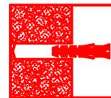
Beiliegendes Befestigungsmaterial eignet sich nur für Massivwände. Für andere Wände müssen Spezialdübel verwendet werden. Die Festigkeit ist zu Prüfen.
