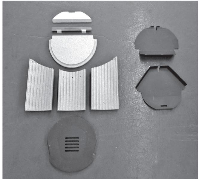
Das Wiedereinsetzen der **Feuerraumauskleidung (8)** erfolgt in umgekehrter Reihenfolge. Achten Sie bei dem hinteren Feuerraum-Auskleidungsteil auf die Position der Tertiärluftlöcher.
