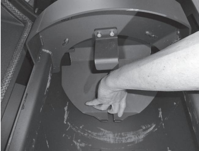
Abschließend muss der Gussboden entfernt werden:
