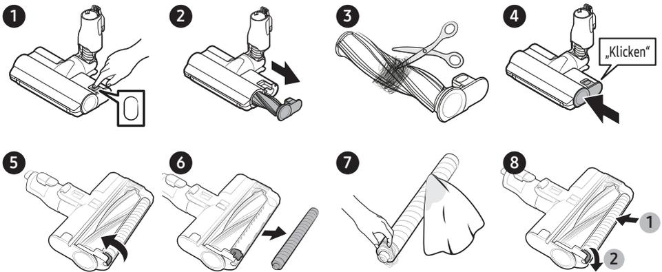
Nehmen Sie eine Schere zu Hilfe, wenn sich die Fremdkörper nicht entfernen lassen.
