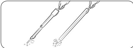
Führen Sie ein langes dünnes Stäbchen ein und drehen Sie es mehrmals, um die Verlängerungsflachdüse oder das Rohr zu reinigen.
