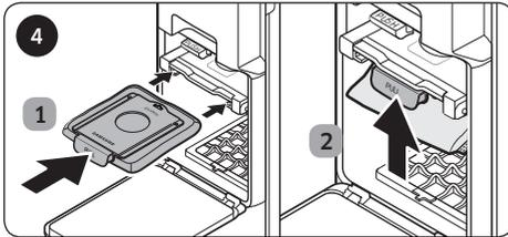
Setzen Sie einen neuen Staubbeutel nach hinten ein und drücken Sie den Hebel „**PULL (ZIEHEN)**“ fest nach oben, bis Sie ihn „einrasten“ hören.
