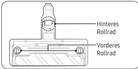
Verwenden Sie einen kleinen Schraubenzieher, um die vorderen und hinteren Rollräder zu entfernen.
