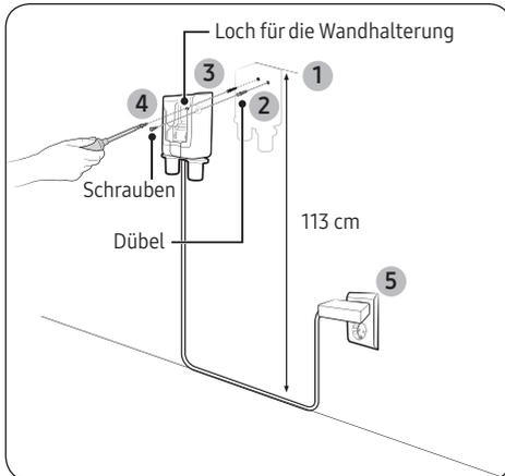
1. Die Wandhalterung sollte so aufgestellt werden, dass sich die Oberkante der Wandhalterung 113 cm über dem Boden befindet.
