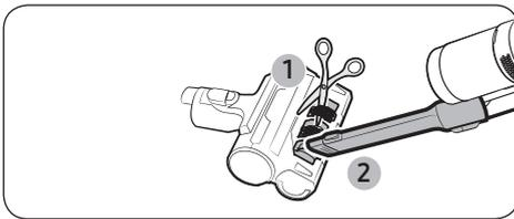
Schneiden Sie die verhedderten Haare oder das Fell mit einer Schere ab, und saugen Sie die Stücke mit einem Staubsauger auf.
