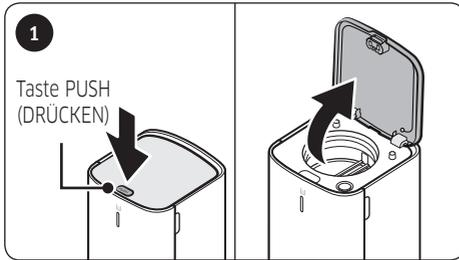
Drücken Sie die Taste **[PUSH (DRÜCKEN)]** auf der oberen Abdeckung der Reinigungsstation.
