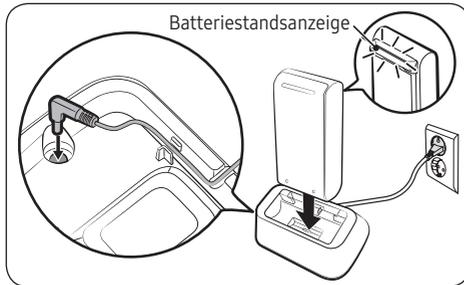
Laden Sie die zusätzliche Batterie in der Batteriehalterung auf.
