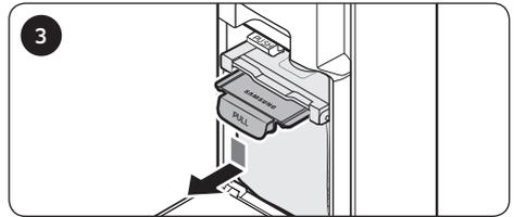
Ziehen Sie den Hebel „**PULL (ZIEHEN)**“, während Sie ihn drücken, um den Staubbeutel zu entfernen.
