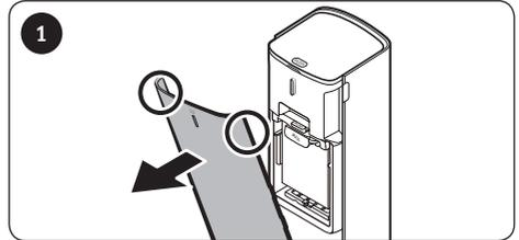
Greifen Sie beide Seiten der vorderen Abdeckung und ziehen Sie die Abdeckung zu sich hin.
