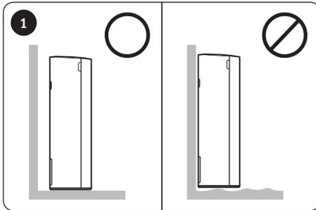
Da sich die Steckdose an der Rückseite des Geräts befindet, stellen Sie das Gerät nicht direkt, sondern mit 10 cm Abstand zur Wand auf einen stabilen Boden.
