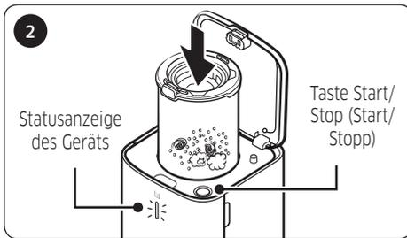
Setzen Sie den Staubbehälter in die Reinigungsstation ein. Drücken Sie die Taste [Start/Stop (Start/Stop)], um den Staubbehälter zu leeren.
