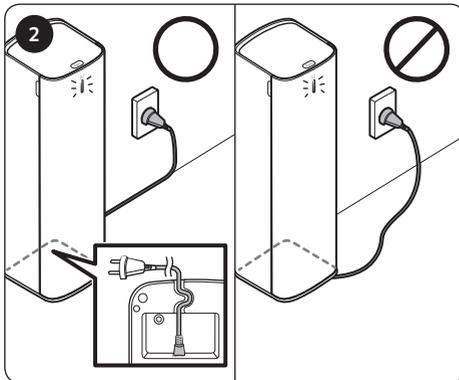
Führen Sie das Netzkabel in die Nut an der Unterseite der Reinigungsstation, legen Sie das Kabel ordentlich an der Wand entlang und schließen Sie das Gerät an.
