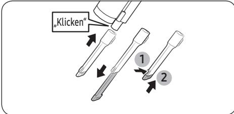
Diese Düse dient zum Entfernen von Staub in Rillen von Fensterrahmen, in schmalen Lücken, Ecken usw.
