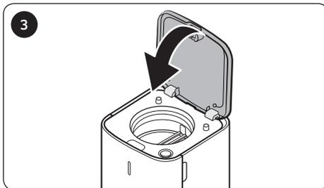
Wenn der Betrieb der Reinigungsstation vollständig beendet ist, ziehen Sie den Staubbehälter heraus und schließen Sie die Reinigungsstation, indem Sie die obere Abdeckung fest andrücken.
