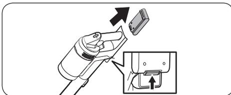
Um die Batterie zu entfernen, drücken Sie die Entriegelungstaste für die Batterie auf der Rückseite des Griffs.
