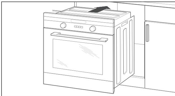
1. Schieben Sie den Backofen in die Einbaueinheit, bis die Frontblende auf den Rahmen des Einbauschranks trifft. Dabei darf die Netzanschlussleitung nicht geknickt, eingeklemmt oder auf andere Weise beschädigt werden.
