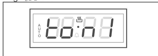
3. Wählen Sie über die **linke** Pfeiltaste den gewünschten Signalton aus (Ton 1 bis Ton 3). Nach etwa 3 Sekunden zeigt das im Display wieder die aktuelle Uhrzeit.
