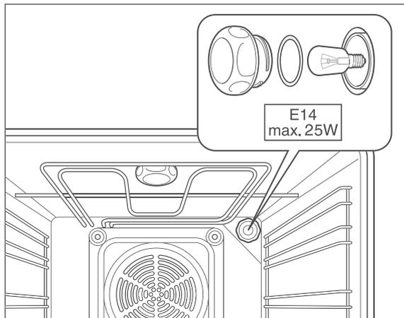
3. Schrauben Sie die Glasabdeckung gegen den Uhrzeigersinn ab und nehmen Sie sie heraus.
