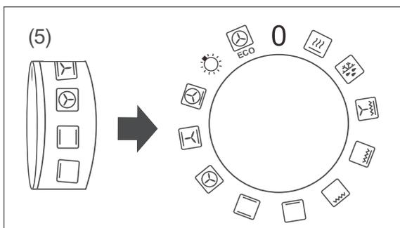
Mit dem Funktionswähler (5) schalten Sie den Backofen ein und wählen die Beheizungsart aus: Die Backofenbeleuchtung und das Außenkühlgebläse werden eingeschaltet. Die Netz-Kontrollleuchte leuchtet.
