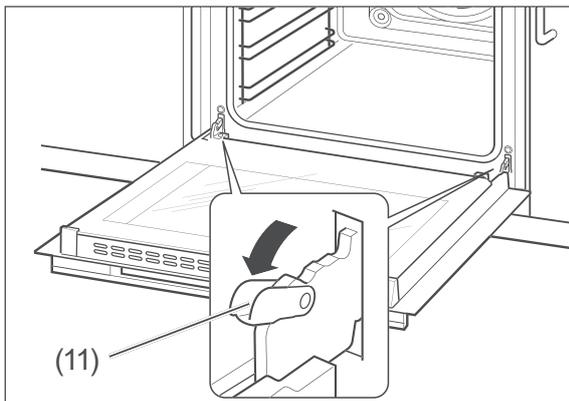
2. Klappen Sie an beiden Seiten die Bügel (11) ganz nach vorne. Nehmen Sie gegebenenfalls einen Schraubendreher zu Hilfe.
