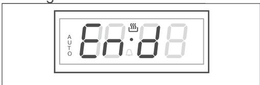
5. Legen Sie über die Pfeiltasten den gewünschten Abschaltzeitpunkt fest (z. B. 12:45). Der Abschaltzeitpunkt kann max. 23:59 Stunden von dem aktuellen Zeitpunkt entfernt sein.
