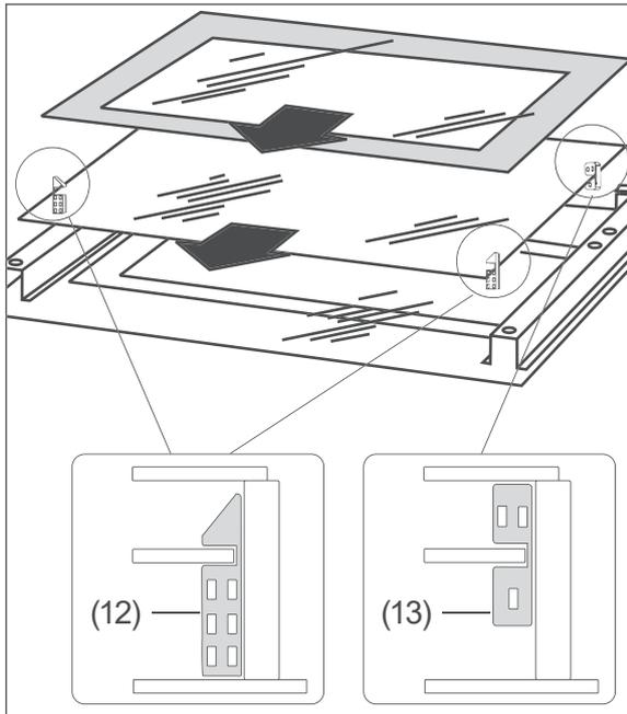
3. Nehmen Sie die obere Scheibe aus der Halterung unten am Scharnier heraus und legen Sie sie sicher ab.
