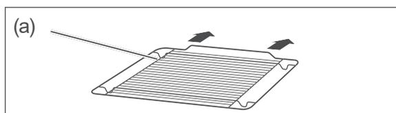
Die mitgelieferten Backbleche (b) und die Fettpfanne (c) haben eine schräge Kante. Nach dem Einschieben sollte diese Kante vorne liegen. Der Grillrost (a) muss wie abgebildet eingeschoben werden.
