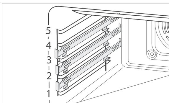
Bitte beachten Sie, dass sich das Backblech etwas unterhalb der Einschubhöhenmarkierung befindet, wenn es auf Teleskopschienen aufliegt (siehe Abb. links).
