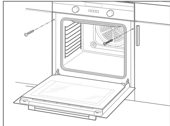
3. Wenn der Backofen richtig ausgerichtet ist, öffnen Sie die Backofentür und schrauben Sie ihn mit den beiliegenden Montageschrauben am Einbauschränk fest.
