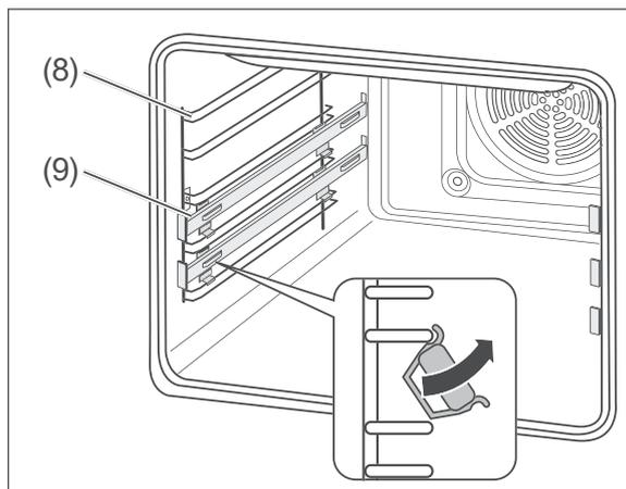
2. Ziehen Sie die Teleskopschienen (9) zunächst von der unteren Führung des Backblechträgers (8) ab und nehmen Sie sie dann nach oben heraus.
