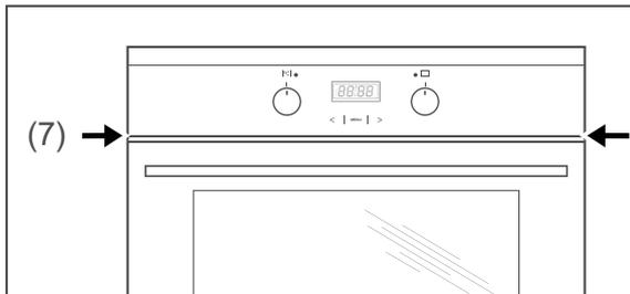
Das Außenkühlgebläse wird automatisch mit dem Backofen ein- und ausgeschaltet. Es kühlt die Backofendämpfe und Grillschwaden, die durch den Wrasenabzug (7) aus dem Backofen treten, und verhindert, dass angrenzende Möbel zu heiß werden.
