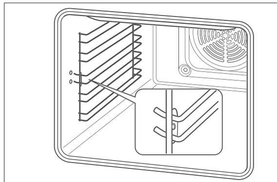
3. Um den Backblechträger (8) zu entfernen, ziehen Sie zuerst die vordere Halterung an der vorderen Seite, an der die beiden Haken mit dem angeschweißten Plättchen sind, mit einem Ruck heraus. Ziehen Sie danach die hintere Halterung des Backblechträgers heraus.
