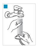
Schrauben Sie den Boden des BWT Quick & Clean-Filtergehäuses mit der Hand ab.
