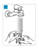
Entfernen Sie die alte Filterkartusche durch Herausziehen aus dem Filtergehäuse.
