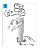
Nehmen Sie die neue Filterkartusche aus der Folienverpackung und führen diese in das Filtergehäuse ein.
