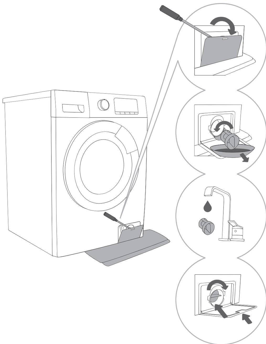
**1** Öffnen Sie die Filterabdeckung mit einem Werkzeug (Schraubenzieher o.Ä.).
