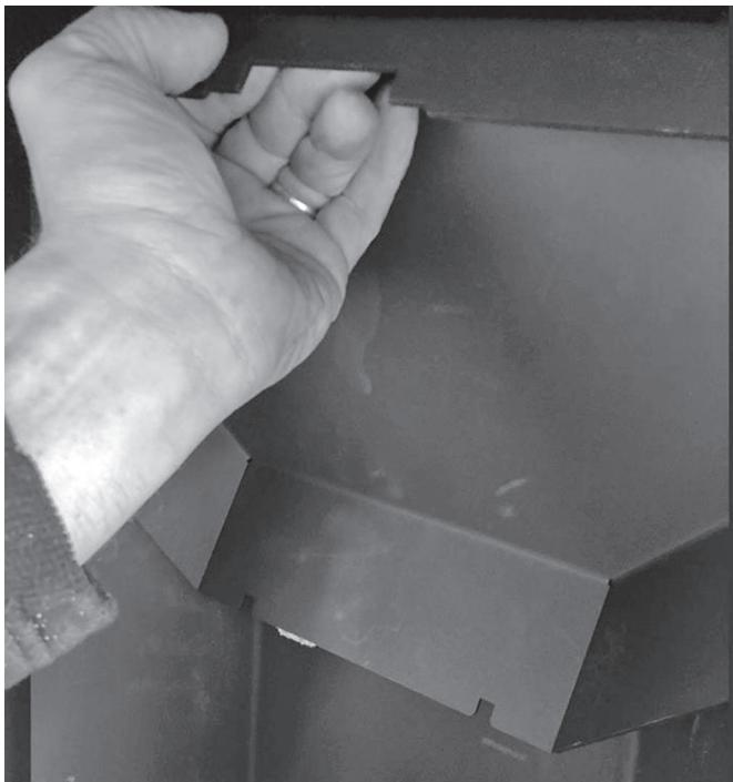
Au-dessus du deuxième déflecteur se trouve un **troisième déflecteur**. Il est également fixé au corps de l'appareil par un système de **fixation à baïonnette**.
