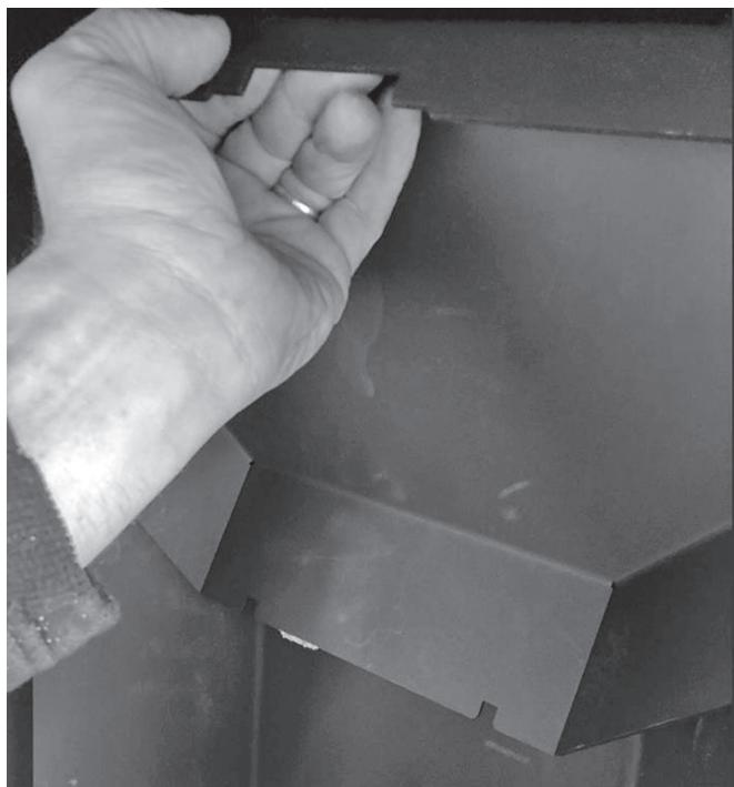
Darüber befindet sich die **3. Heizgasumlenkung**. Sie ist hinten am Gerätekörper ebenfalls in einer **Bajonetthalterung** eingehangen.
