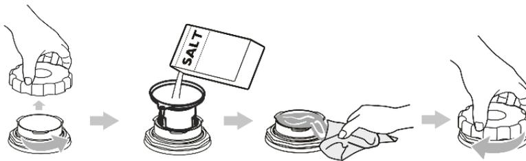
1. Unterkorb entfernen, Deckel des Salzbehälters abschrauben.
