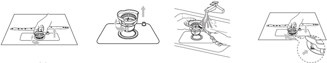
Grobfilter (2) gegen den Uhrzeigersinn drehen und die Filter nach oben anheben.
