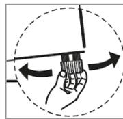
Prüfen Sie mit einer Wasserwaage, ob das Gerät waagerecht steht. Wenn das Gerät nicht im Gleichgewicht steht, müssen die Standfüße justiert werden.
