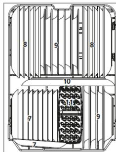
Der untere Korb ist aufgrund der besonders intensiven Reinigungswirkung des unteren Sprüharms für das stark verschmutzte Geschirr geeignet. Räumen Sie z. B. Töpfe und Teller ein.
