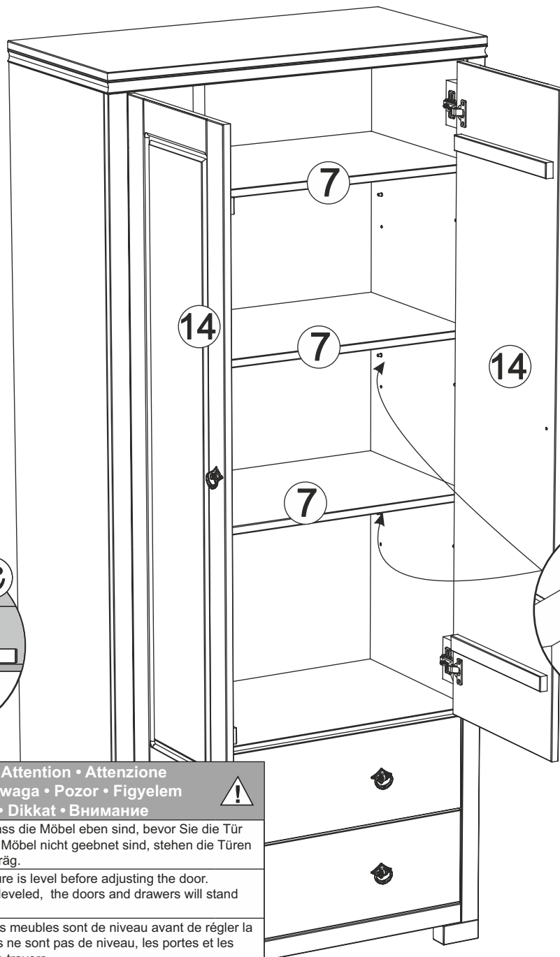
Türverstellungsschema (falls erforderlich) Door adjustment scheme (if necessary)
