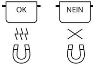
Ausschließlich Töpfe und Pfannen aus ferromagnetischem Material verwenden, die für die Verwendung mit Induktionskochfeldern geeignet sind:
