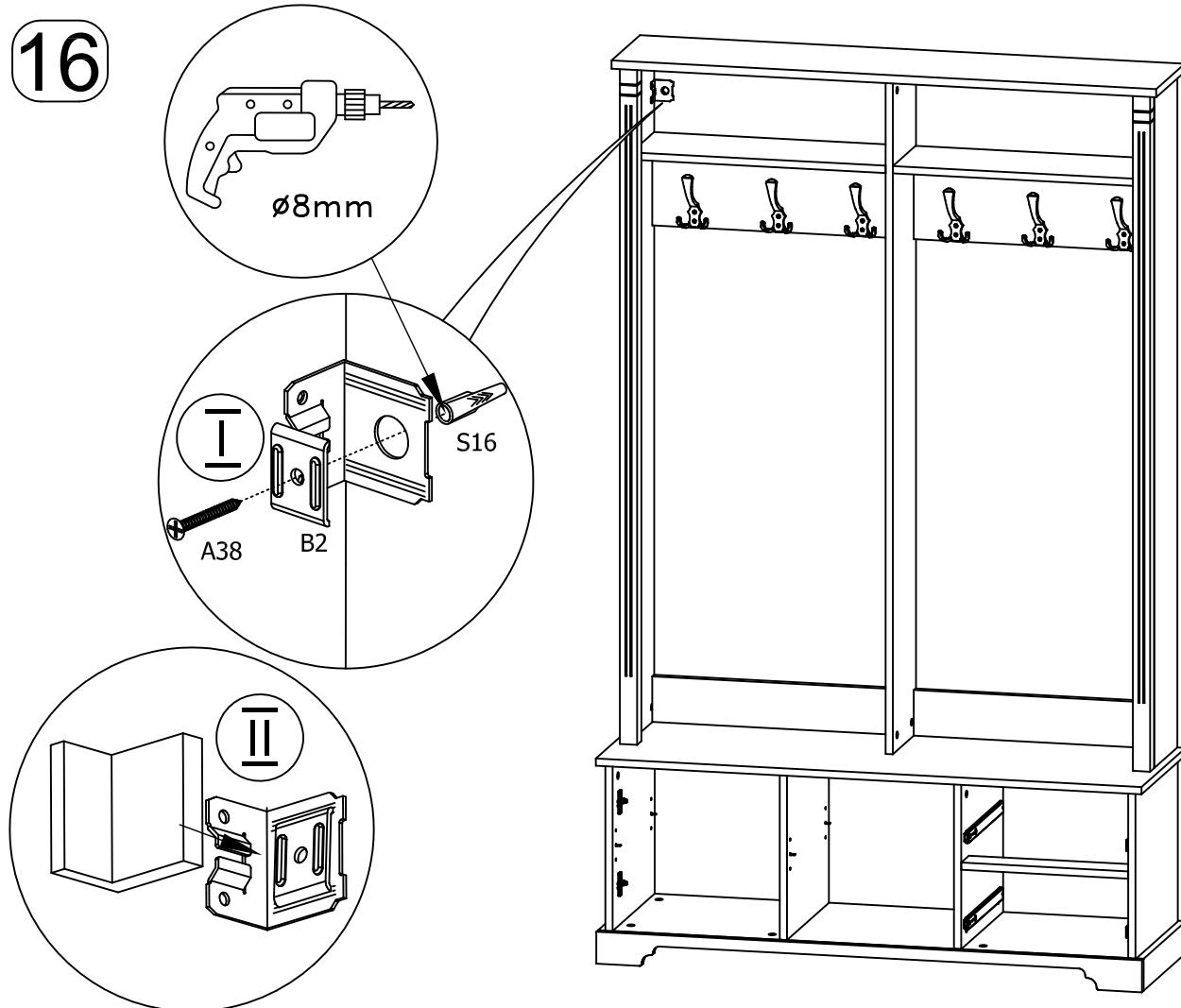
**D** Das beigelegte Wandbefestigungsmaterial (Dübel und Schrauben) eignet sich nur für festes Mauerwerk (z.B. Beton- oder Ziegelwände). Für andere Wandaufbauten sind eventuell Spezialdübel und andere Schrauben notwendig. Ziehen Sie gegebenenfalls eine Fachkraft zurate.
