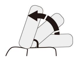
Um eine Kopfstütze wieder in die flache Position zu bringen, bewegen Sie sie zunächst in die äußerstmögliche Neigung; danach fällt sie in die flache Position zurück.
