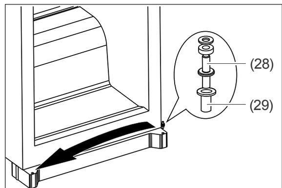
8. Setzen Sie den unteren Scharnierbolzen (28) um. Achten Sie darauf, dass Sie auch die Aufnahmehülse (29) für den Scharnierbolzen mit umsetzen.
