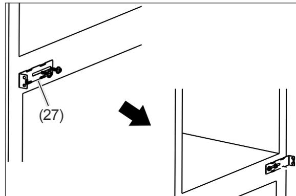
6. Demontieren Sie den Befestigungswinkel (27) und schrauben Sie ihn auf der gegenüberliegenden Seite wieder an.
