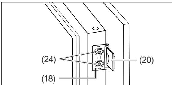
3. In den Außenkanten der Gerätetüren sind Löcher zur Befestigung der Gleiter (18) vorgebohrt. Schrauben Sie je 2 Gleiter pro Tür mithilfe der kurzen Schrauben (24) an den zu öffnenden Seiten fest.
