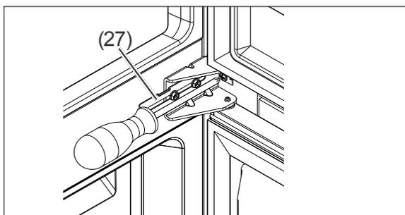
15. Verschrauben Sie abschließend auch die beiden Befestigungswinkel (27) zwischen
