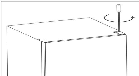
3. Demontieren Sie die obere Scharnierplatte. Verwenden Sie zum Herausdrehen der Schrauben einen 8er Schraubenschlüssel oder einen Kreuzschlitz-Schraubendreher.
