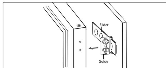
9. Schrauben Sie die Gleiter wieder ab und schieben Sie sie auch die montierten Schleppschiene.
