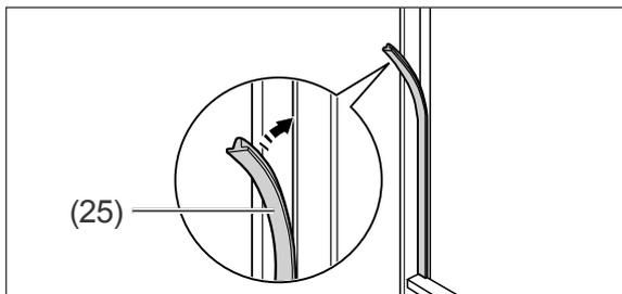
14. Drücken Sie bei geöffneten Kühlgerätekammertüren das Dichtungsprofil in den Spalt zwischen dem Kühlgerät und dem Einbauschränk.
