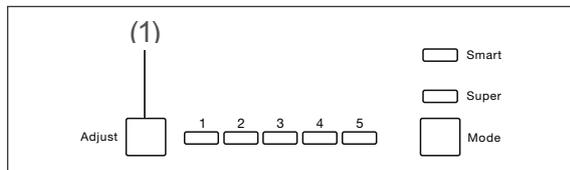
Um das Gerät aus- und einzuschalten, halten Sie die Taste Adjust (1) 5 Sekunden lang gedrückt.
