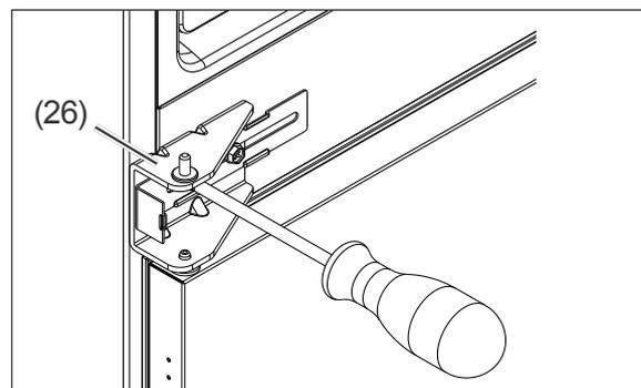
10. Montieren Sie das Mittelscharnier (26) auf der gegenüberliegenden Seite wieder an.
