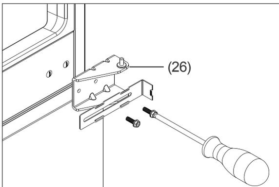
5. Demontieren Sie das Mittelscharnier (26).
