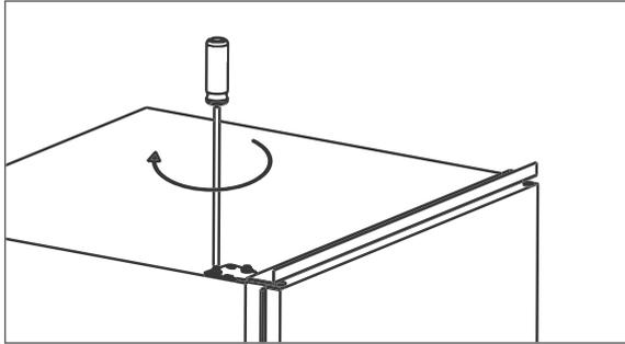
12. Montieren Sie die obere Scharnierplatte wieder an.
