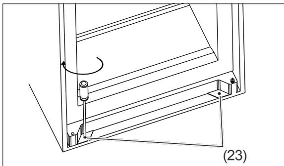
13. Wenn sich die Türen einwandfrei öffnen und schließen lassen, verschrauben Sie das Kühlgerät mit dem Einbauschränk. Verwenden Sie dafür oben 3 kurze Schrauben (24) und unten die beiden langen Schrauben (23).
