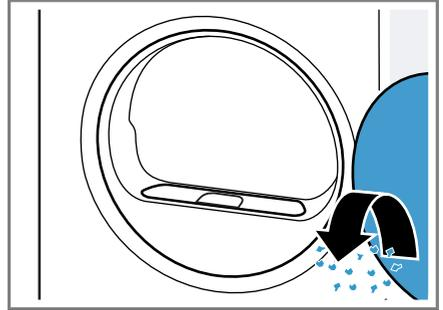
3. Das zweiteilige Flusensieb entfernen.
