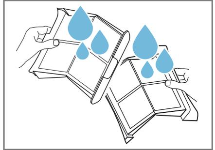
9. Die beiden Flusensiebe schließen und zusammensetzen.
