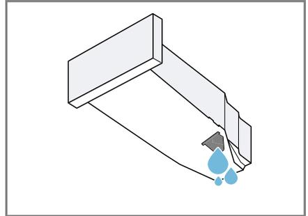
Prüfen Sie regelmäßig den Filter des Kondenswasserbehälters und reinigen Sie einen verunreinigten Filter. → Seite 38
