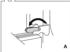
**2 A** Drehen Sie die Aushängesperre bis zum Anschlag zurück (gilt für klassisches Schließen).
