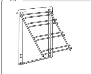
Entfernen Sie die Draht- bzw. Ausziehführungen.
