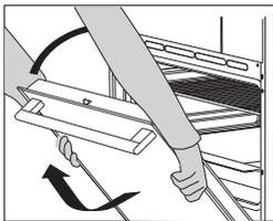
**3** Machen Sie die Gerätetür langsam zu, damit die Sperren auf den Halterungen aufsitzen. Heben Sie die Gerätetür ein wenig an und ziehen Sie sie aus beiden Scharnierhalterungen heraus.
