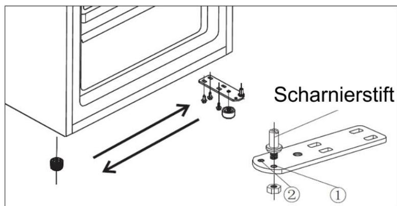
9. Das untere Scharnier mit den Befestigungsschrauben und dem verstellbaren Fuß auf der linken Seite montieren.
