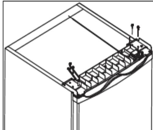
15. Die Gerätetür horizontal und vertikal ausrichten. Darauf achten, dass die Dichtungen gut schließen.
