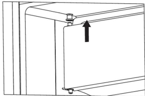
9. Die untere Halterung auf der linken Seite auf den Stift der Gefrierfachtür setzen und anschrauben.
