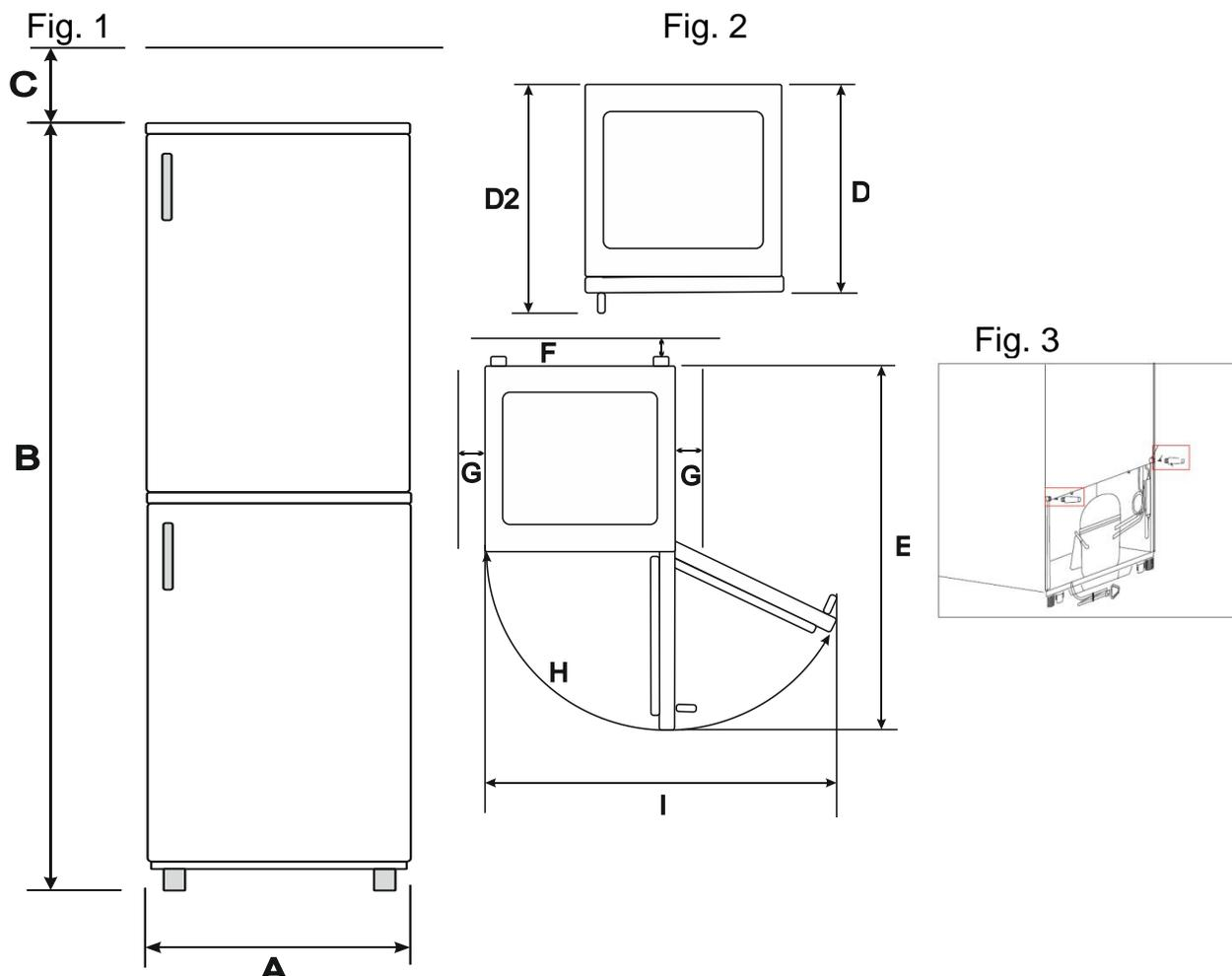
Zur Einhaltung der Abstände und zur Erreichung der angegebenen Energieklasse sind die beigefügten Abstandshalter am Gerät anzubringen. Sie werden direkt hinten am Gerät fixiert (siehe Zeichnung unten)
