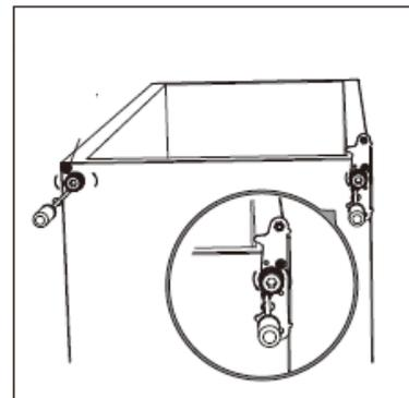
10. Mit einer Zange den Stift vom Scharnier lösen, das Scharnier um 180° drehen und den Stift wieder einsetzen.
