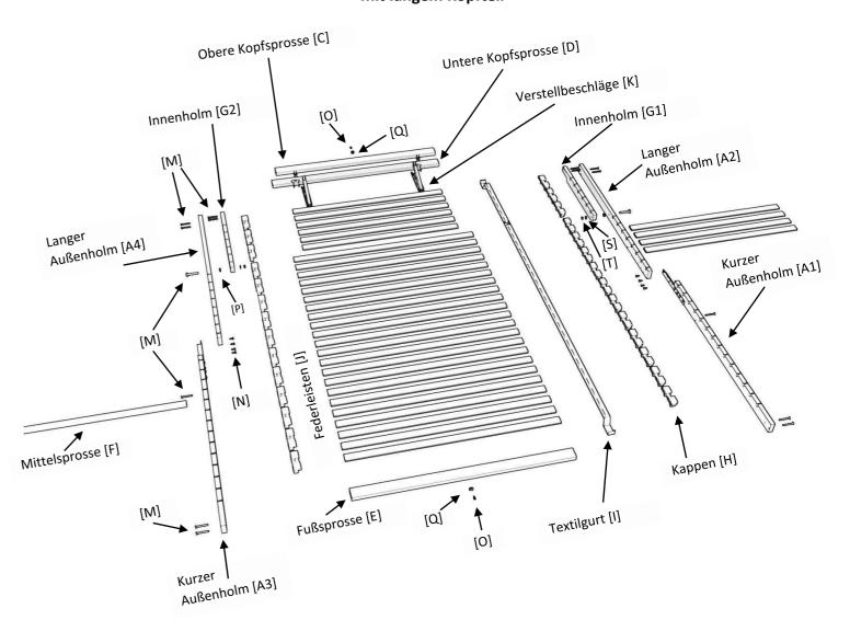
Abbildung ähnlich und technische Änderungen vorbehalten, je nach Ausführung unterschiedliche Anzahl von Federleisten möglich. Nutzen Sie die beiliegende Musterkarte und orientieren Sie sich an den nachfolgenden Montageschritten.
