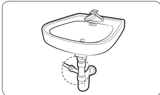
2. Schließen Sie den Schlauchanschluss direkt an das Abflussrohr des Waschbeckens an.
